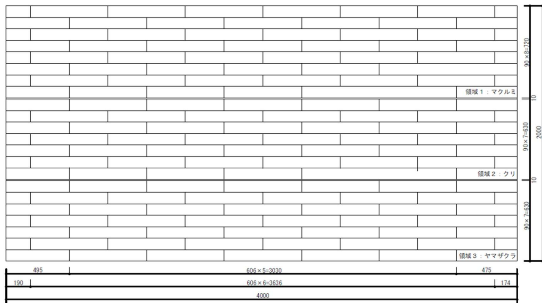
図 2-1 試験体図(フローリング割付図、施工時に確認) 単位：mm
